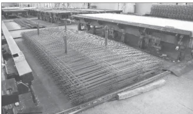
Комплекующая сетка для армирования дорожной плиты.
