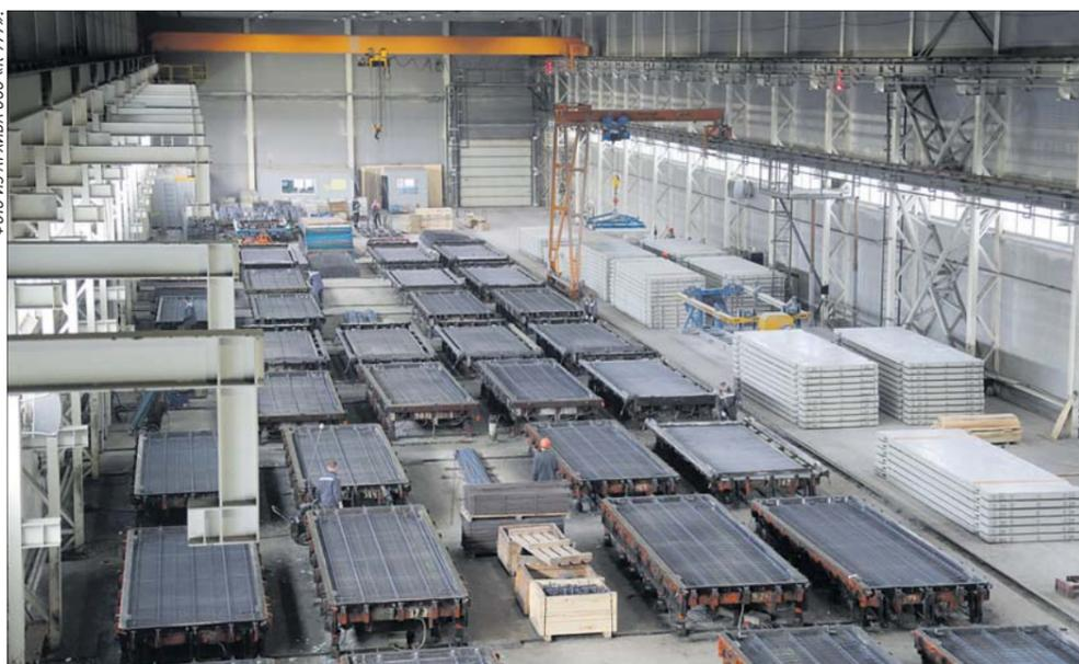
Общий вид цеха по производству дорожных плит напряжения (ПДН).
